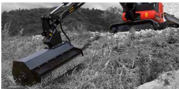
Circuit hydraulique pour tête tranchante avec pompe supplémentaire (22 l/min)
