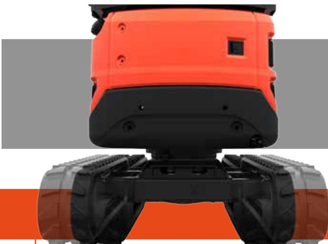
Le truck roulant et la lame peuvent être élargis de 990 mm à 1300 mm, en assurant une stabilité élevée et par conséquent une mobilité d'intervention complète.
