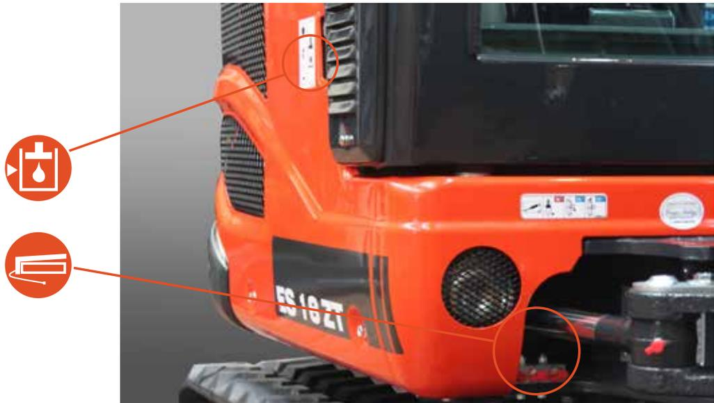
Batterie, fusibles, et remise à niveau huile hydraulique peuvent être atteints à travers des logements spécifiques sur la partie antérieure du poste de conduite.
